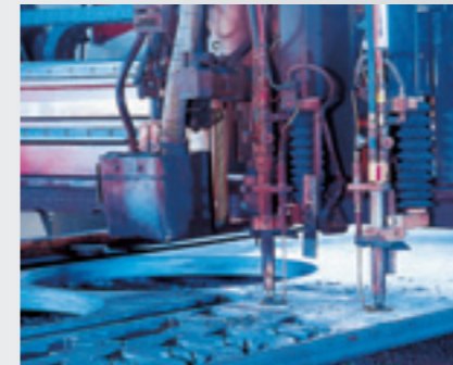
Autogen- und Plasmabrenner | Je nach Vormaterial wird die optimale Brennart gewählt.
