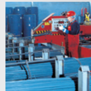
Schneidautomat Betonstahl | Genaue Zuschnitte bis zu 14 m.
