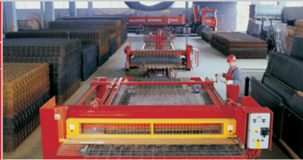
Betonstahlmattenbearbeitung | Herstellung von Mattenkörben auf unserer Fertigungsstraße.
