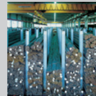
Betonstahlvorratslager | Längen von 12 bis 18 m.
